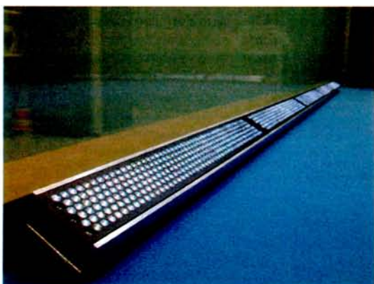
Rund 10 000 weiße LEDs, die mit den Panels und den Projektoren synchronisiert werden müssen, leuchten die Szenerie aus.
