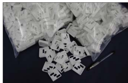
Bild 2: Glasgestrahlte Elektrogehäuse aus PA12, hergestellt nach der SLS-Technik. Die Lieferzeit betrug drei Tagen ab Datenanlieferung.
