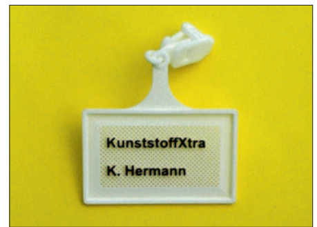
Bild 4: Hergestellt in einem Arbeitsgang mit der EOS P 760: personalisiertes Namensschild aus PA 12 mit Scharnier, Gelenk, und Feder.
