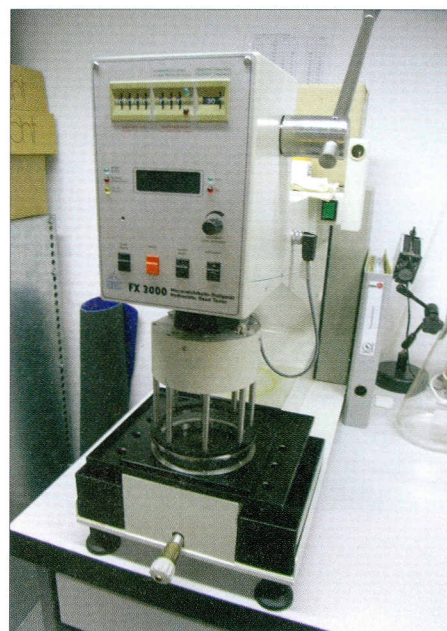
Bild 1: FX-3000-Hydrotester von Textest zur Bestimmung der Wasserdichtheit von gesinterten PA12-Probekörpern mit unterschiedlichen Beschichtungen.
