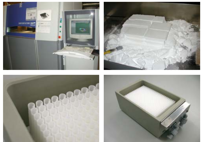
Bild 2: Produktionsablauf (lasersintern, auspacken, Montage, fertiger Waschblock (Bild: irpd))
