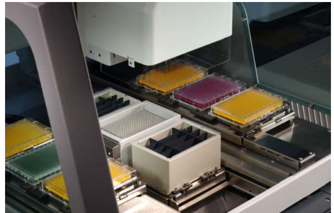
Bild 6: fertig montierter Waschblock, bereit für den Einsatz im DMSO oder Isopropanol (Bild: Tecan)
