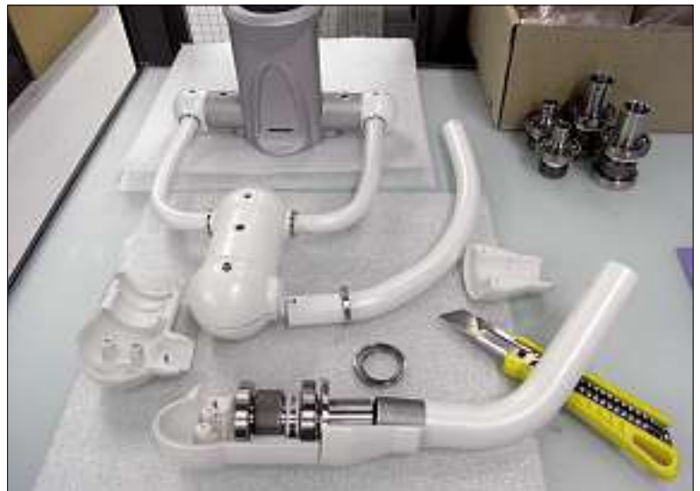
Abb. 5: Detail- und Vor-montage der Kardan-Komponenten am irpd.
