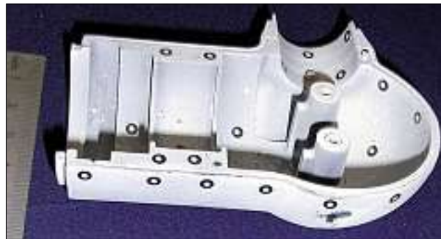
Abb. 3: Bauteil aus Produktion mit Referenzmarken.
